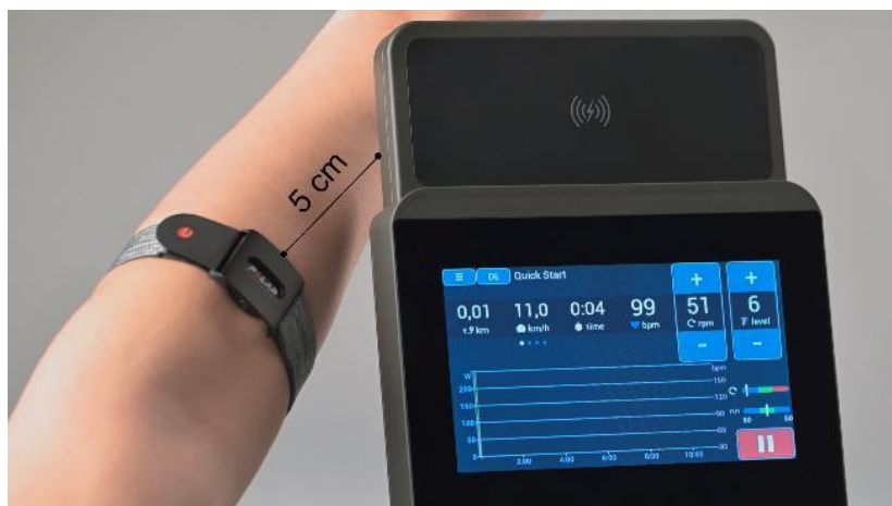
Фиг.: Сдвояване на ANT+ сензор за предаване на сърдечната честота
