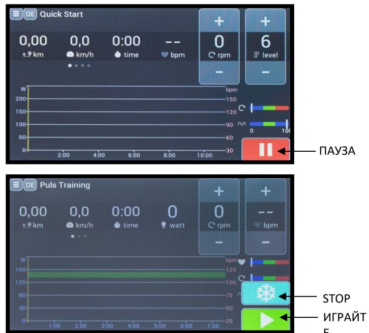
Фиг. 2: Изглед на монитора, обясняващ функциите на бутоните, действителният изглед може да се различава по цветът, но предназначението на бутоните е същото.
