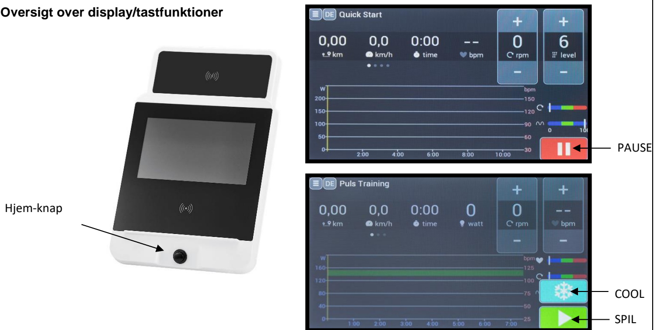
Fig. 2: Skærmvisning, der forklarer knappernes funktioner, den faktiske visning kan variere i farverne, men knaptildelingen er den samme.
