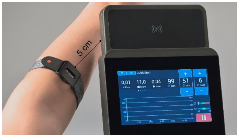
Fig. 11: Parring af en ANT+-sensor til pulstransmission
