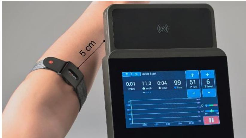
Abb. 11: Pairing eines ANT+ Sensors zur Herzfrequenzübertragung
