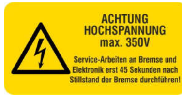
Abb.6: Warnhinweis an Bremse wegen Gefahr durch Hochspannung.
