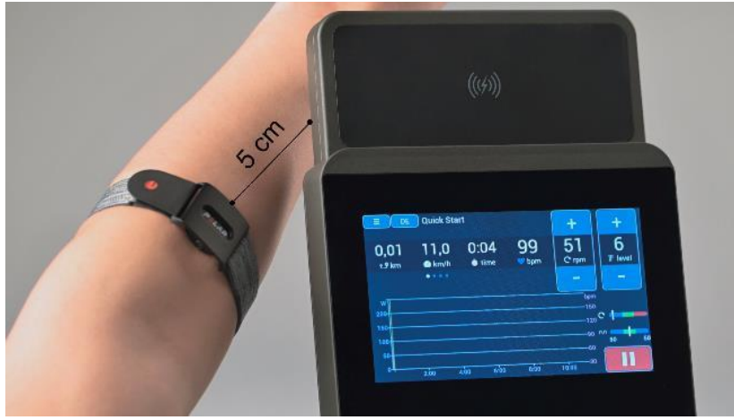
Kuva 11: ANT+-anturin pariiloituksen muodostaminen sykkeen lähettämistä varten.
