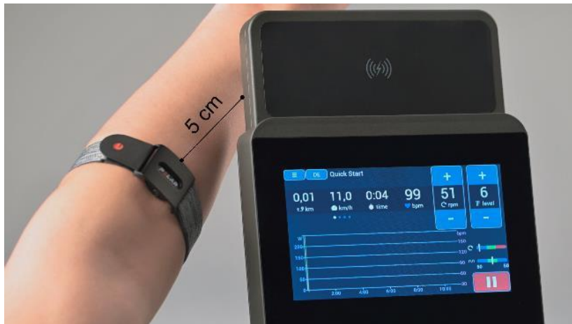
Fig. 11 : Appariement d'un capteur ANT+ pour la transmission de la fréquence cardiaque
