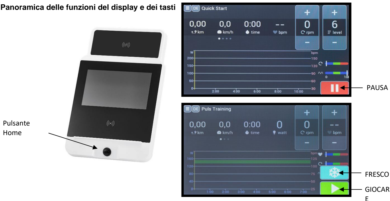
Fig. 9: Vista del monitor, con spiegazione delle funzioni dei pulsanti; la vista reale può variare nei colori, ma l'assegnazione dei pulsanti è la stessa.
