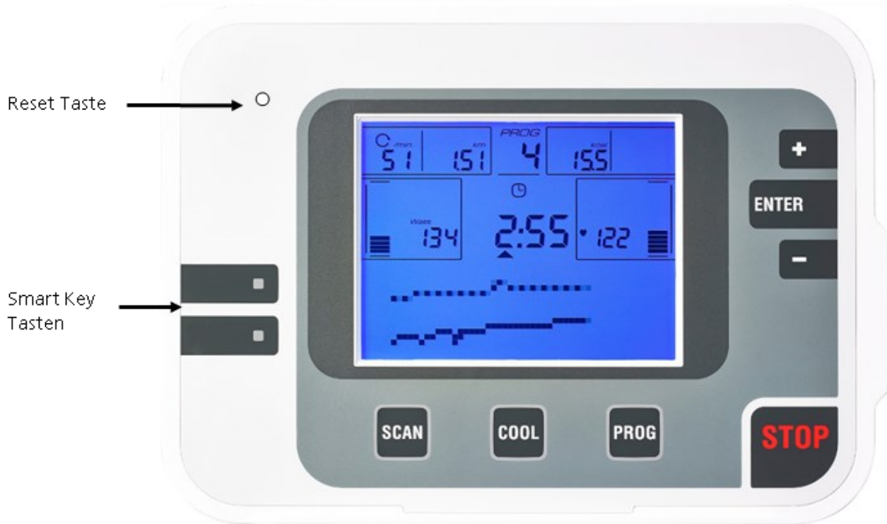
Figura 2: vista frontale del monitor, che spiega le funzioni dei pulsanti
