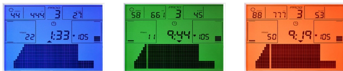
Fig.4: Retroilluminazione multicolore come biofeedback per indicare il rispetto dell'obiettivo.
