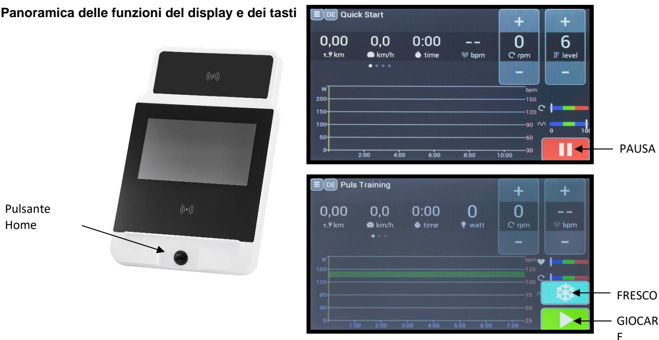
Fig. 2: Vista del monitor, con spiegazione delle funzioni dei pulsanti; la vista reale può variare nei colori, ma l'assegnazione dei pulsanti è la stessa.
