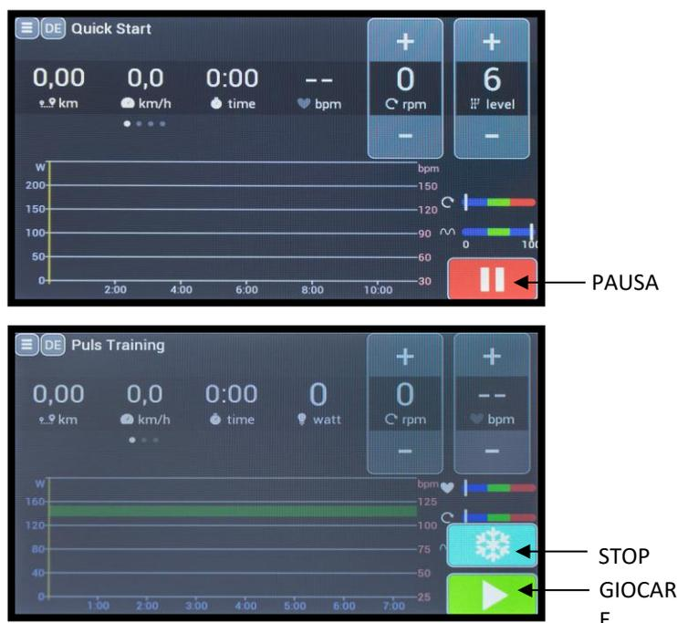
Fig. 2: Vista del monitor, con spiegazione delle funzioni dei pulsanti; la vista reale può variare nei colori, ma l'assegnazione dei pulsanti è la stessa.
