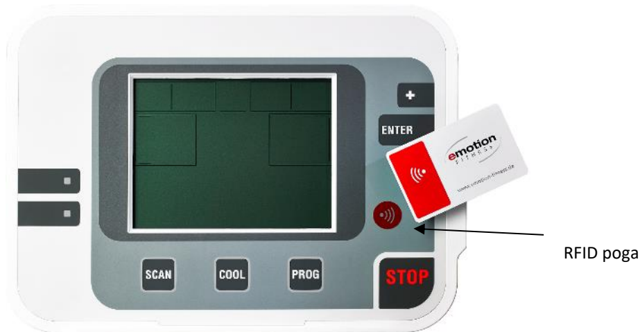
5. attēls: RFID poga RFID noteikšanai, ja nav ievietots datu nesējs. var vai vajadzētu
