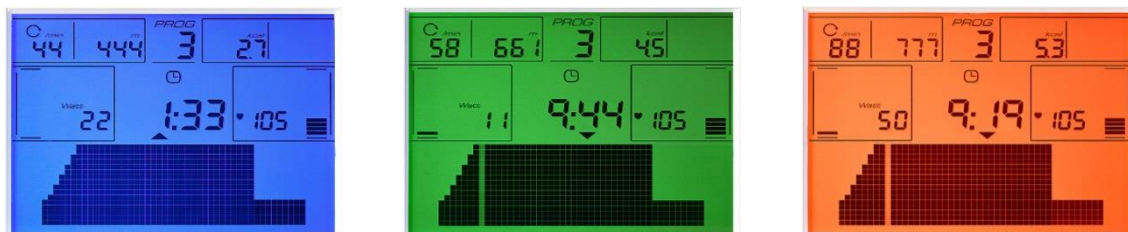
4. attēls: Daudzkrāsu aizmugurējais apgaismojums kā bioloģiskā atgriezeniskā saite, lai norādītu atbilstību mērķim.
