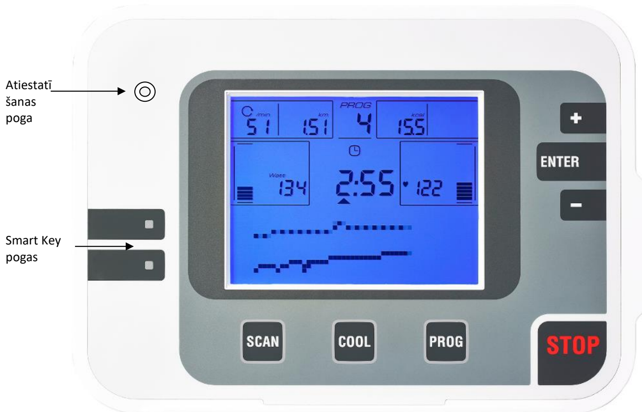
2. attēls: Monitors priekšējais skats, kurā paskaidrotas pogu funkcijas
