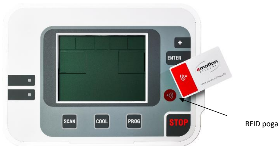
5. attēls: RFID poga RFID noteikšanai, ja nesēju nevar vai nedrīkst ievietot.
