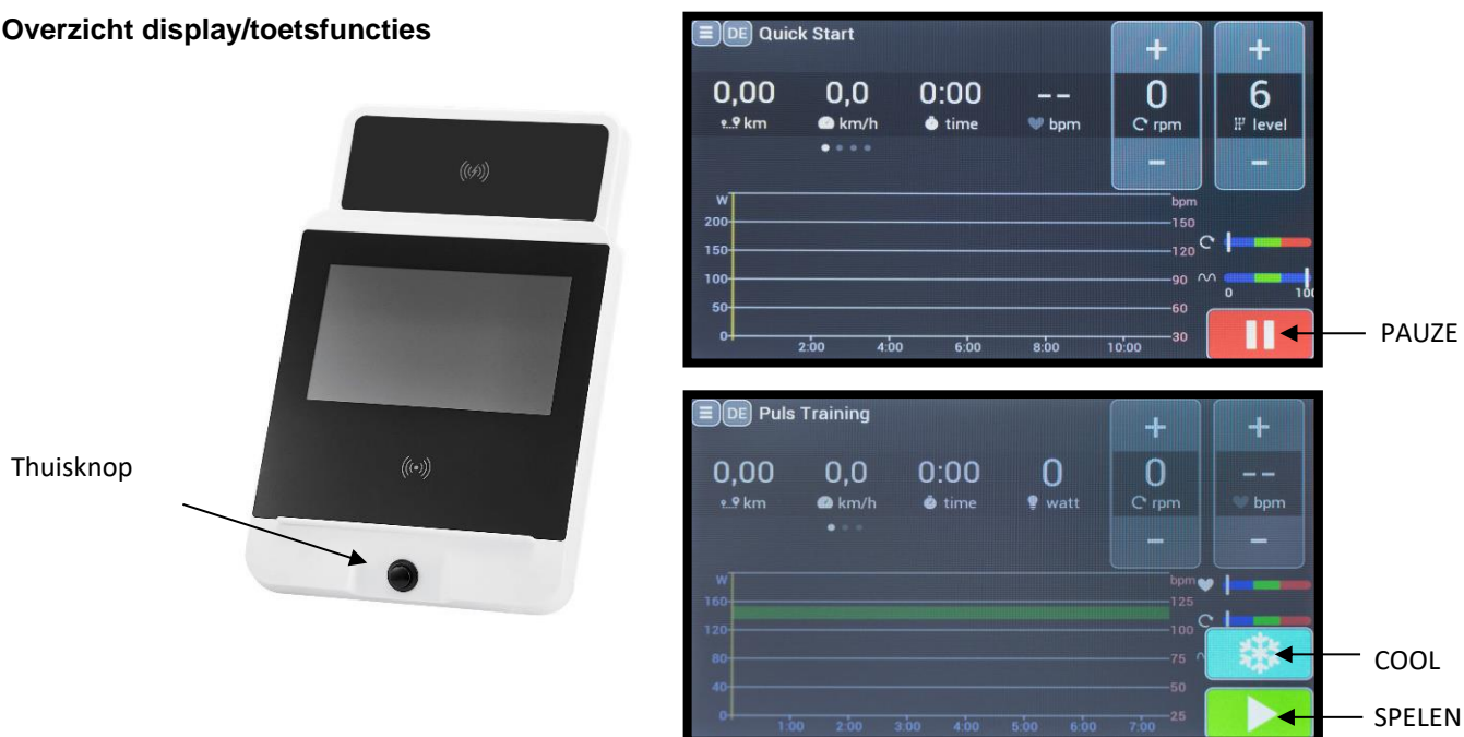
Fig. 2: Monitorbeeld, met uitleg van de knopfuncties, het werkelijke beeld kan in kleur variëren, de toewijzing van de knoppen is hetzelfde.
