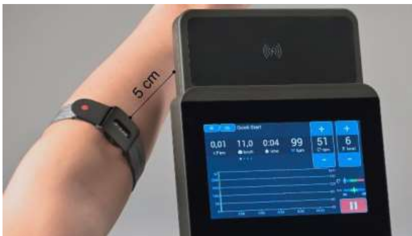
Fig. 11: Een ANT+ sensor koppelen voor hartslagoverdracht
