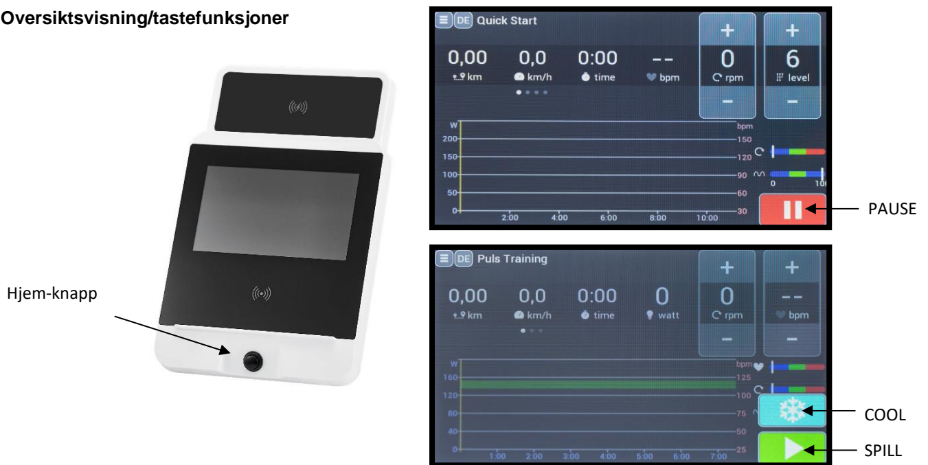
Fig. 2: Skjermvisning som forklarer knappefunksjonene, den faktiske visningen kan variere i farge, knappetilordningen er den samme.
