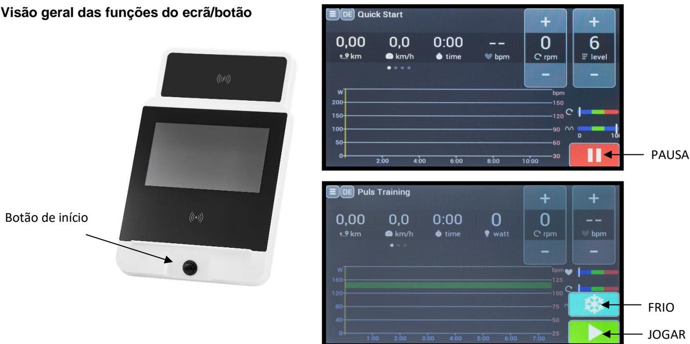
Fig. 2: Vista do monitor, para explicar as funções dos botões, a vista real pode variar em termos de cor, a atribuição dos botões é a mesma.
