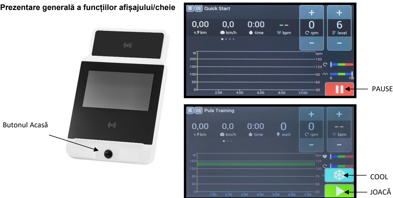
Fig. 9: Vizualizarea monitorului, explicând funcțiile butoanelor, vizualizarea reală poate avea culori diferite, dar atribuirea butoanelor este aceeași.
