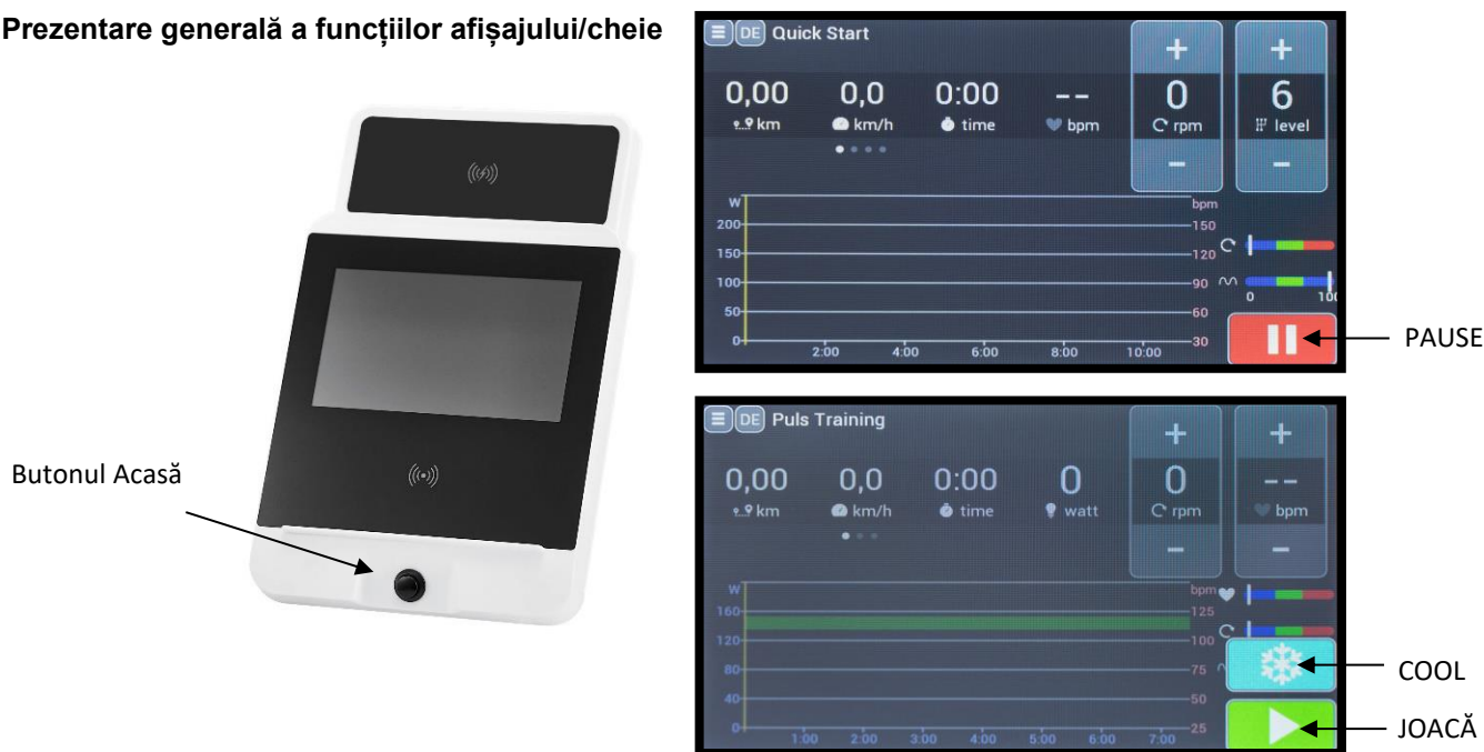
Fig. 2: Vedere a monitorului, explicând funcțiile butoanelor, vederea reală poate avea culori diferite, dar atribuirea butoanelor este aceeași.
