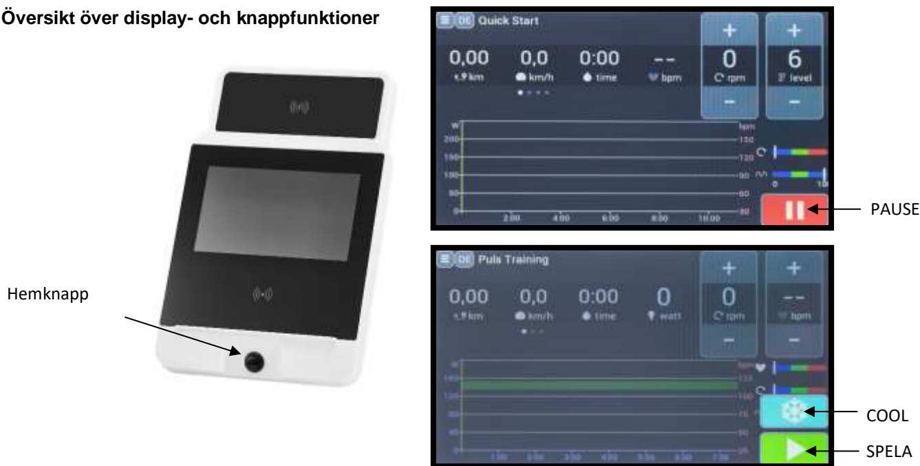
Fig. 9: Monitorvy, för att förklara knappfunktionerna, den faktiska vyn kan variera i färg, knapptilldelningen är densamma.
