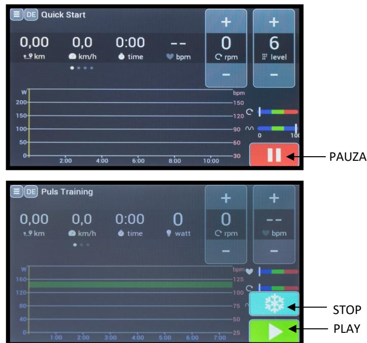
Obr. 2: Zobrazenie monitora s vysvetlením funkcií tlačidiel, skutočné zobrazenie sa môže farebne lísiť, priradenie tlačidiel je rovnaké.
