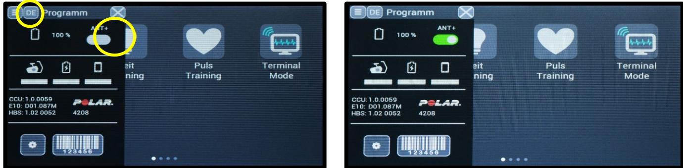
Obr. 4: Aktivácia ANT+ na prenos srdcovej frekvencie
