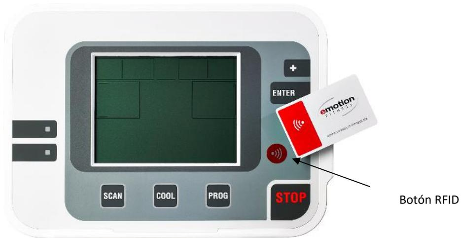
Fig.5: Botón RFID, para la detección de RFID si el medio no puede o no debe ser insertado
