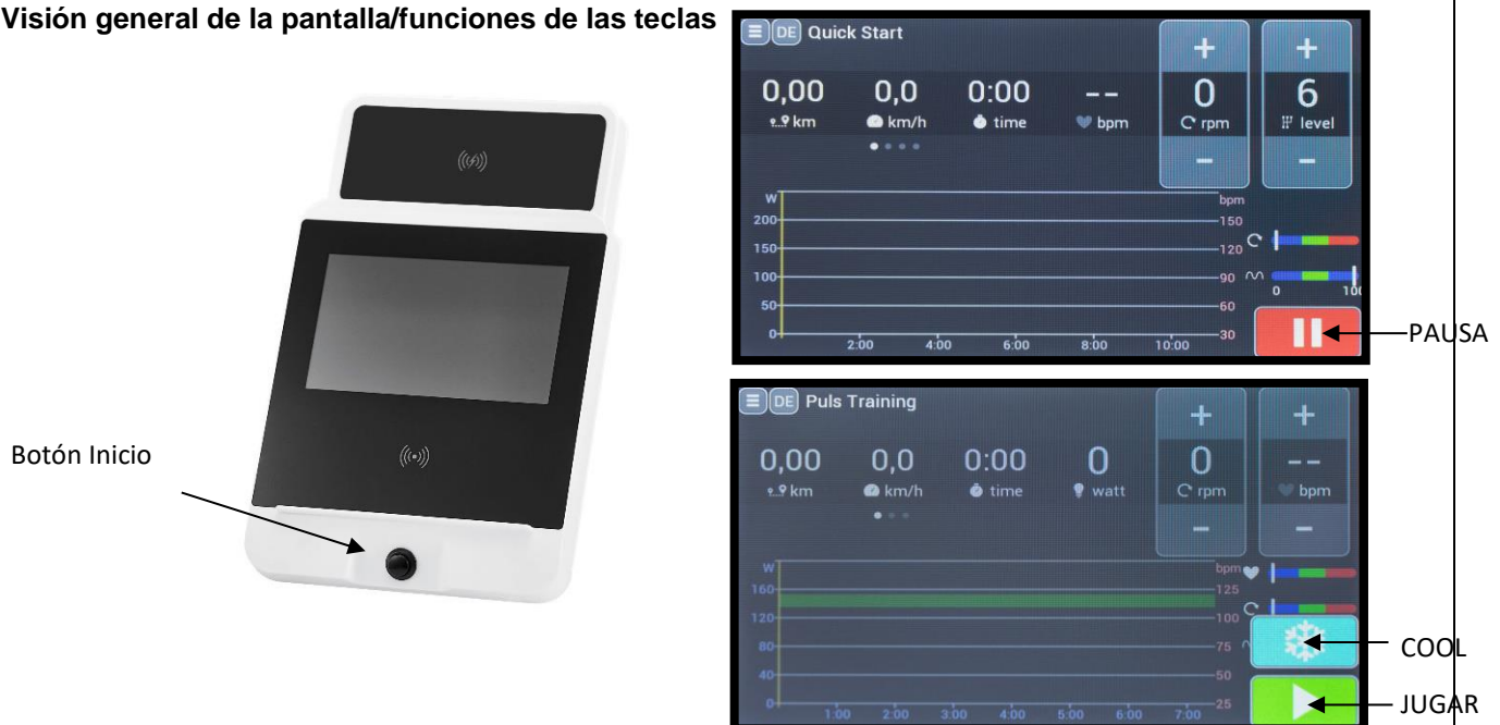
Fig. 9: Vista del monitor, explicando las funciones de los botones, la vista real puede variar en color, la asignación de los botones es la misma.
