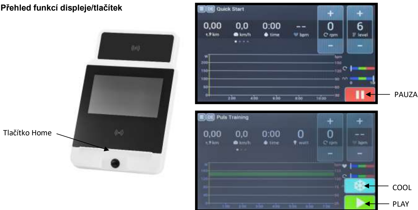
Obr. 9: Zobrazení monitoru pro vysvětlení funkcí tlačítek, skutečné zobrazení se může barevně lišit, přiřazení tlačítek je stejné.
