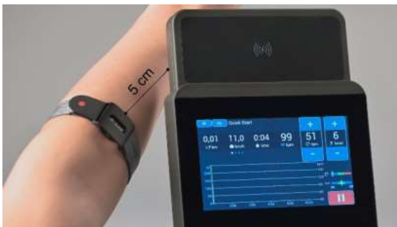
11. ábra: ANT+ érzékelő párosítása a pulzusszám átviteléhez
